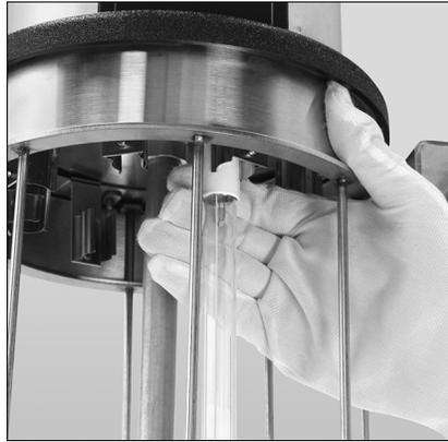
**Paso 4** - Presione con el pulgar en el exterior del **Sanidyne® Prime Remote**, encaje la base de la lámpara al clip que se encuentra en la parte superior del portalámparas.
