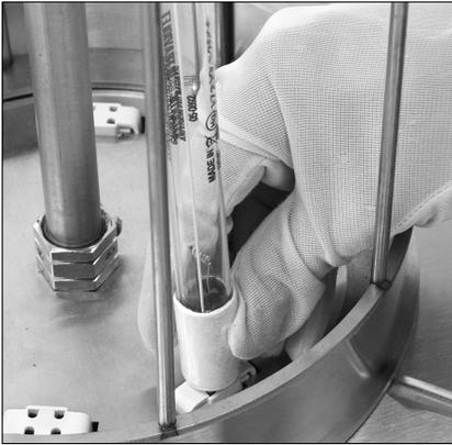
**Paso 3** - Cuando tenga las patillas alineadas correctamente, presione levemente la base de la lámpara hasta que esté bien insertado en el zócalo del portalámparas.
