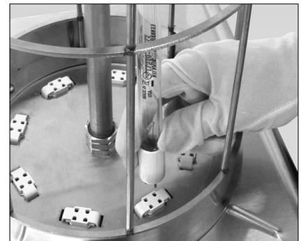
**Paso 2** - Alinee las patillas en la base de la lámpara al zócalo del portalámparas, como se muestra. (**Instalación de la Lámpara continua en la página 10.**)
