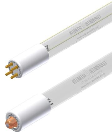
Las Lámparas Germicidas **STER-L-RAY**<sup>®</sup> son tubos de onda corta que producen ondas ultravioleta letales para los microorganismos. Aproximadamente el 95% de la energía ultravioleta emitida por las lámparas **STER-L-RAY**<sup>®</sup> está a 254 nanómetros, potencia germicida más destructiva para las bacterias, el moho y los virus
