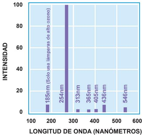
Eficiencia Germicida Relativa a la Longitud de la Onda
