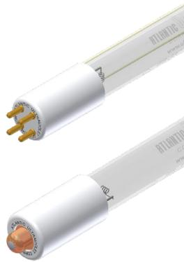
Las Lámparas Germicidas **STER-L-RAY**® son tubos de baja presión y longitud de onda corta que producen ondas ultravioleta letales para los microorganismos. Aproximadamente el 95% de la energía ultravioleta emitida por las lámparas **STER-L-RAY**® es 254 nanómetros, potencia germicida más destructiva para las bacterias, el moho y los virus.
